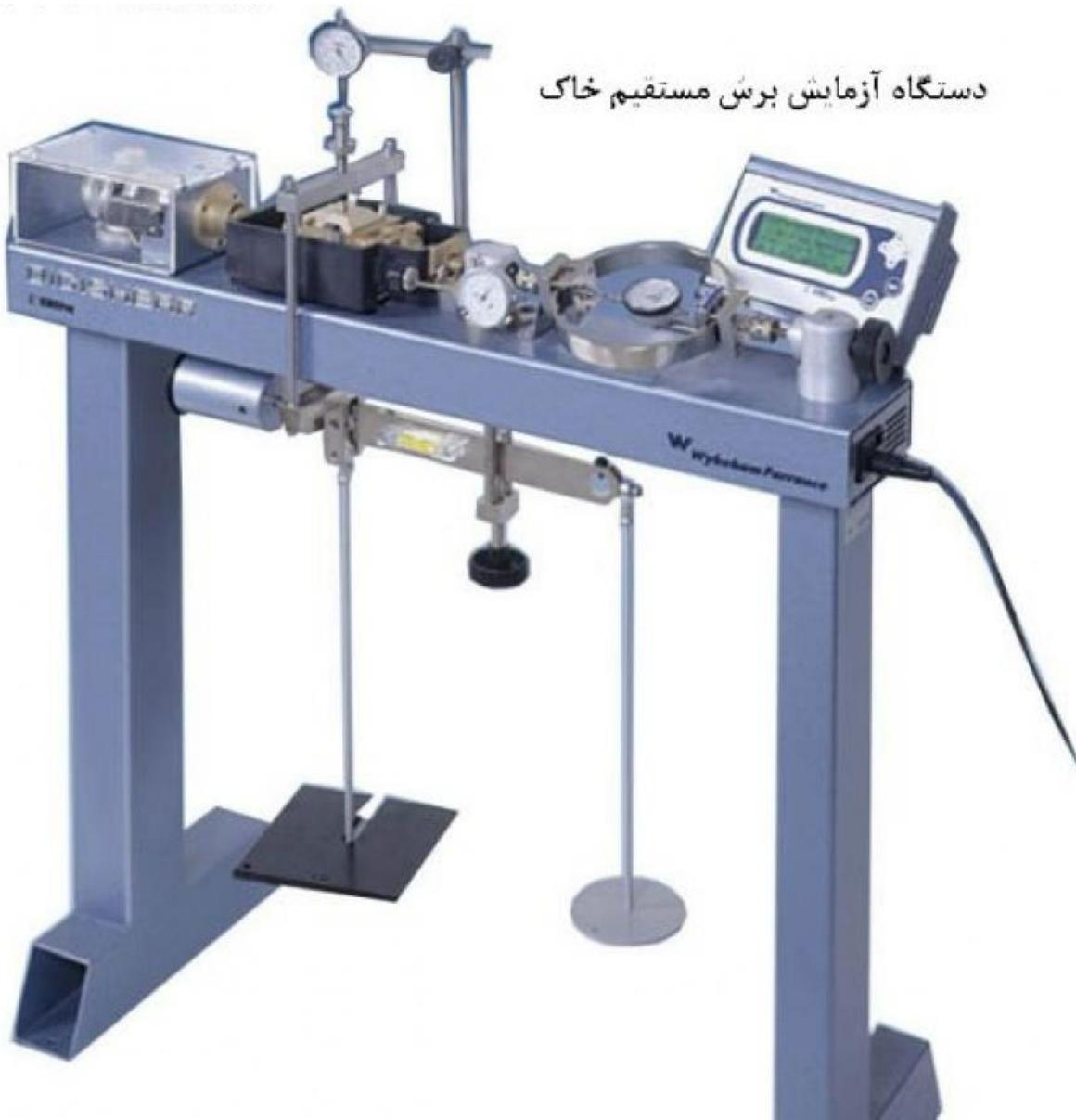
هدف از این آزمایش، تعیین پارامترهای مقاومت برشی خاک است.
