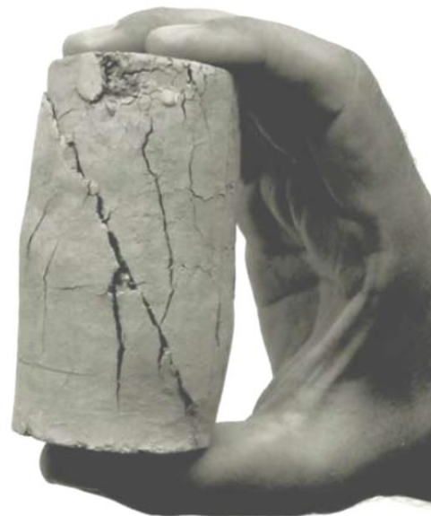
شکل ۱۲-۳۵ گسیختگی برشی نمونه خاک در آزمایش فشاری محدود نشده.
