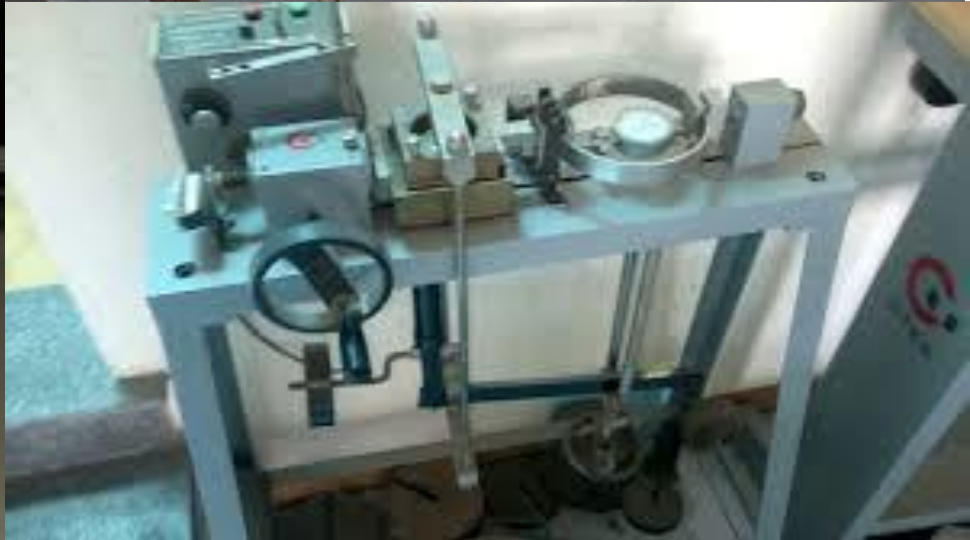
شکل ۱۲-۶ در این تصویر عقربه‌های اندازه‌گیری و نیروسنج حلقه‌ای نصب شده دیده می‌شوند.
