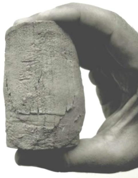
شکل ۱۲-۳۵ گسیختگی برشی نمونه خاک در آزمایش فشاری محدود نشده.
