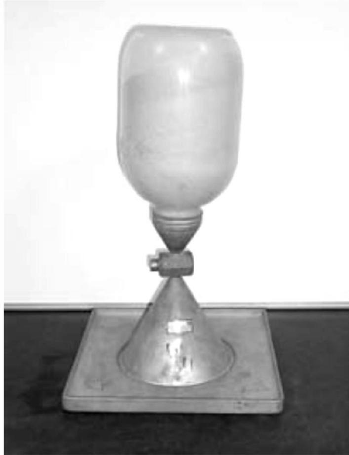
این آزمایش برای به دست آوردن وزن واحد حجم خشک خاک در حالت طبیعی یا یک لایه خاک کوبیده شده با استفاده از مخروط ماسه کالیبره شده یا بالون لاستیکی است.
