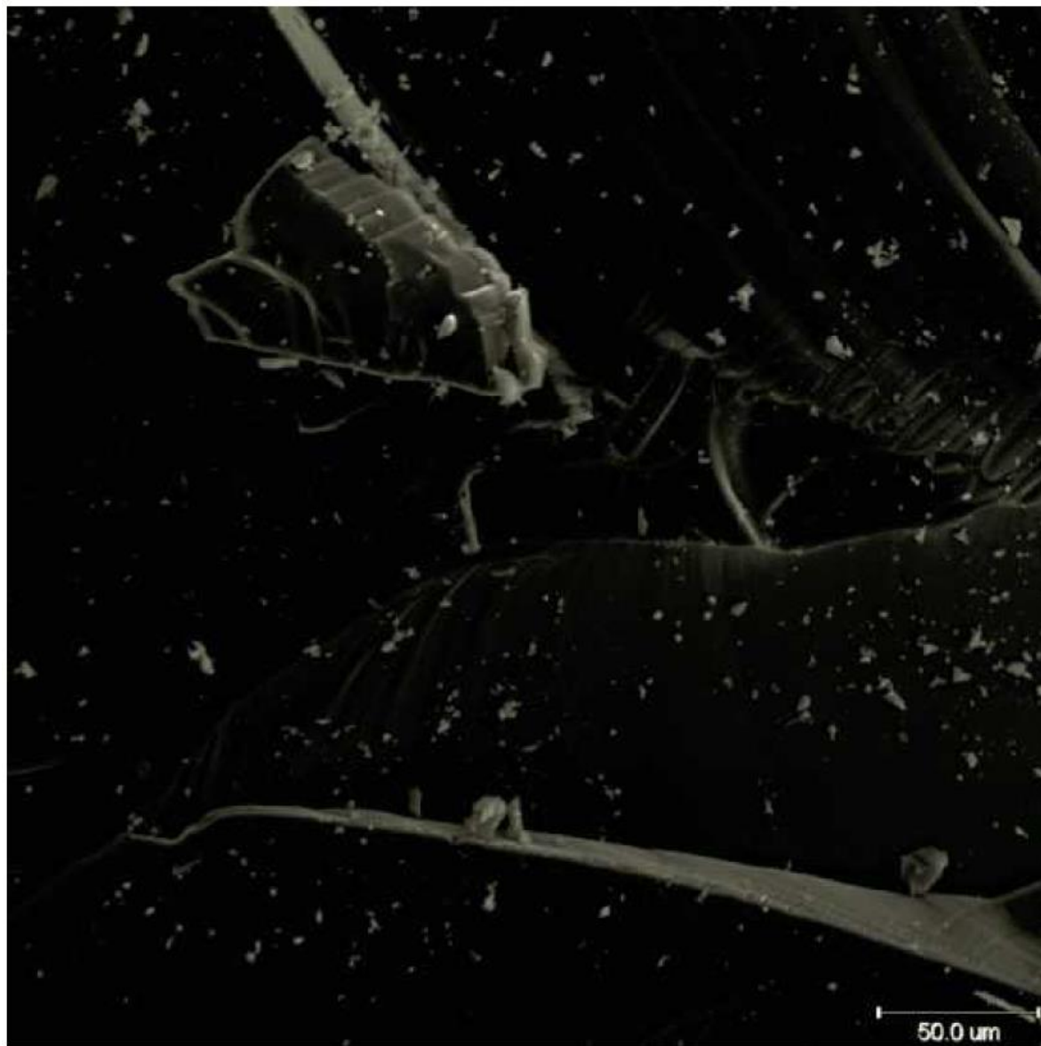
شکل ۲-۳ ریزنگار اسکن شده الکترونی سطح شکسته کوارتز، شکستگی‌های شیشه مانند را با سطح صفحه‌ای ناسوخته نشان می‌دهد.
